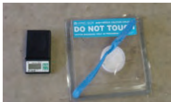
Calcium Chloride Test – ASTM F1869
