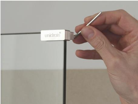
Glasbeslaget til topstangen placeres på hjørnet af brusevæggen og spændes til med de to pinolskruer, der sidder i beslaget.
